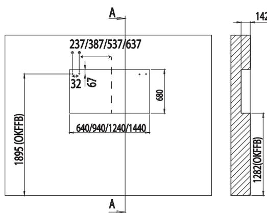
Bei Waschtischanlagen mit Befestigungsschrauben müssen die Maße zum Bohren vor Ort, nach dem Auflegen des Waschtisches auf den Unterschrank, angezeichnet werden.
